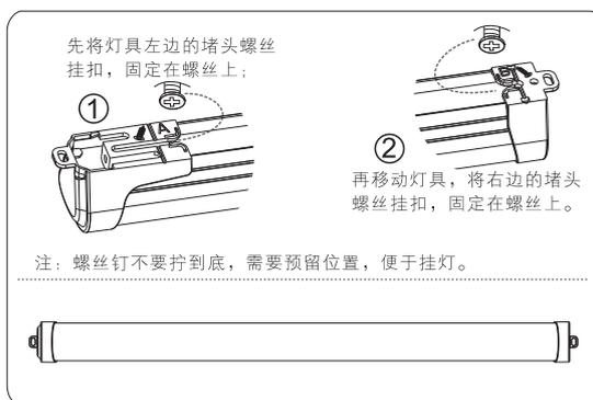
将灯具固定在螺丝上；打开电源开关，测试灯具是否正常工作。
