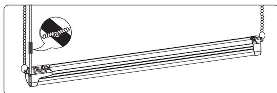
将灯具固定在吊线上；打开电源开关，测试灯具。
