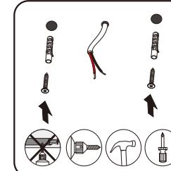
1 根据灯具吊挂孔距在天花板上打孔，并装上墙塞和螺丝
