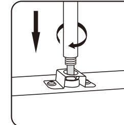
1 将电源线穿入吊杆中，再将吊杆旋转进吊装螺母即可
