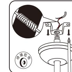
2 将支架用螺丝固定在天花板上，再按接线图正确接线，再将吸盘和吊杆旋进支架内
