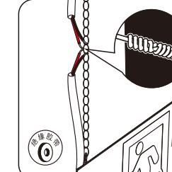
2 用吊链或钢绳吊装好灯具，接线图线正确接线，并用绝缘胶带做好防护处理
