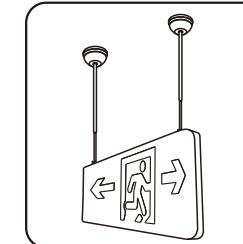
3 接通电源，然后按灯具安装顺序进行编址，并在控制器中进行模拟试验灯具是否正常
