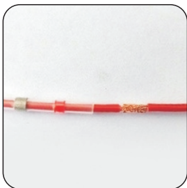
连接好电源线，将热缩焊锡环移至连接处
