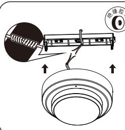
2 按接线图正确接线，并用绝缘胶袋做好防护处理，将灯具从下往上卡进安装支架上
